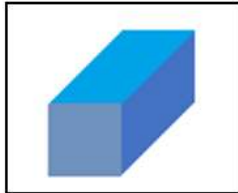
Figuur 10: Een volume geometrie (ISO 19107:2003 Spatial Schema).
